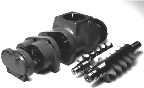
Figure 5. Oil flooded screw compressor Slika 5. Uljem potopljen vijčani kompresor
